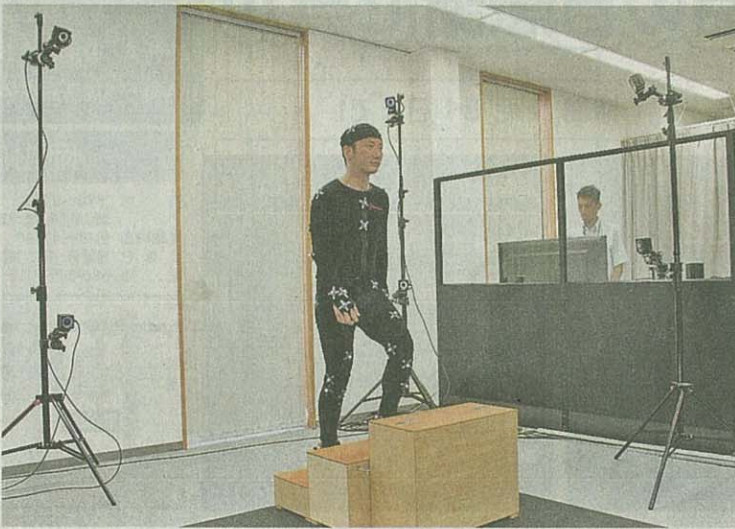
全身サポーターを装着した時の体の動きを分析するモーションキャプチャーシステム
