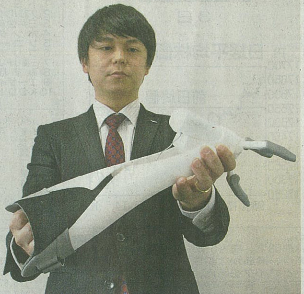
電動義手の試作品。機能を絞り軽量・低価格化を図る
